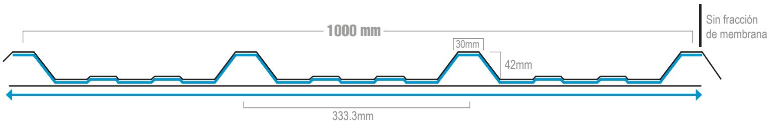
ZINCASTOP es una membrana absorbente que se clasifica dentro de la línea industrial de ZINCASUR. Su aspecto es de felpa grisácea y está fabricada 100% en fibras de poliéster, sin aditivos químicos en las fibras. Esta va adherida en la cara inferior de las cubiertas de zinc gracias a un poderoso adhesivo que hace que su terminación sea perfecta.
