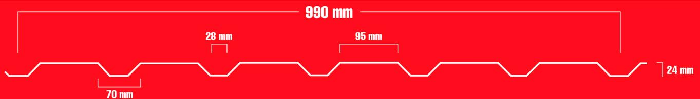
Las cubiertas Z-RIB INVERTIDO se usan tanto para revestimientos de interior como exterior, y se clasifican dentro de la línea arquitectónica de ZINCASUR. Puede ser instalado de forma horizontal o vertical y tiene un propósito estético, pero también estructural gracias a sus 7 nervios trapezoidales. Este es un diseño exclusivo de Zincasur que mezcla el diseño con la funcionalidad del acero pintado.
